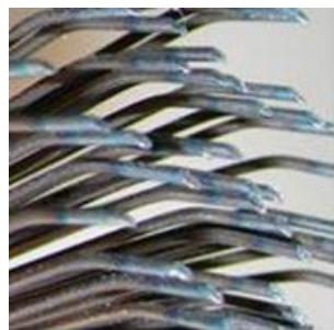
электроприводные приборы MBX Bristle Blaster германского производства MONTI Werkzeuge GmbH со специальными насадками в виде щёток с изогнутыми закаленными прутками и с опцией пылеулавливания. Визуально полученную после обработки поверхность со степенью очистки St3 и шероховатостью 40-120 мкм сложно отличить от поверхности Sa2½, полученной при помощи стандартной абразивоструйной очистки. Затраты на данную технологию сравнительно невелики.
