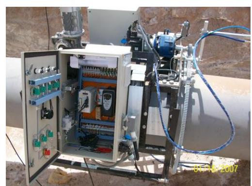
Абразивоструйный и окрасочный комплексы имеют достаточную продольную устойчивость, на качественное нанесение покрытия установками не влияет фактор эллипсности трубы в сечении, комплексы также устойчивы в части преодоления ими вертикальных и горизонтальных уклонов до 15°.
